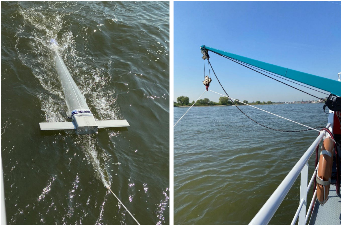
Abbildung 4: Probenahme im Rhein mit dem Forschungsschiff Max Prüss. Ein Manta-Trawl (links) wird mittels Kran (rechts) neben dem Schiff an der Wasseroberfläche positioniert.
