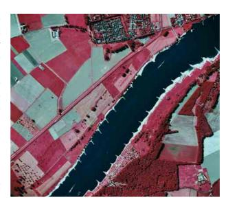
Bild 15: Buhnenausbau bei Zons.
