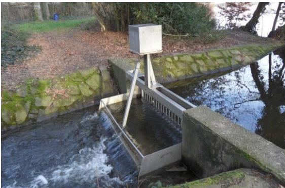
Wasserstandsmessgerät, nicht als Bauwerk zu erheben
