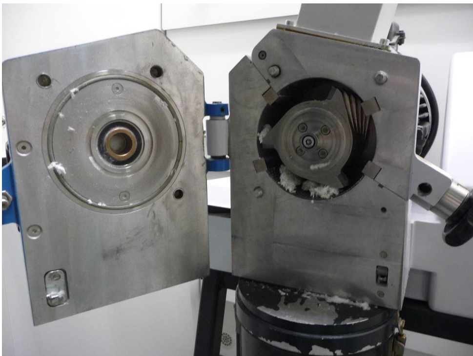
Abbildung 2: Geöffnete Schneidmühle mit Überresten einer Vliesprobe im Mahl-/Schneidraum
