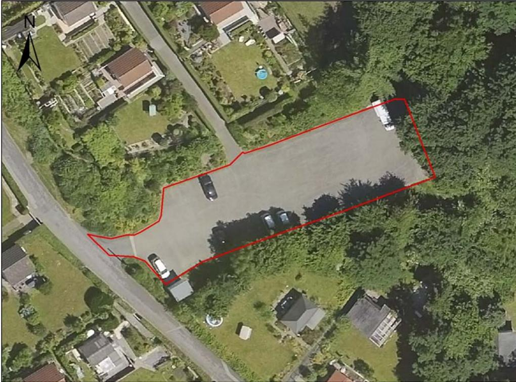
**Abbildung 9:** Belagsänderungs- und Teilentsiegelungspotenzial eines geringfrequentierten Parkplatzes (Quelle: Geodaten der Stadt Solingen (SG62-1-15-1640.1 (2015)))
