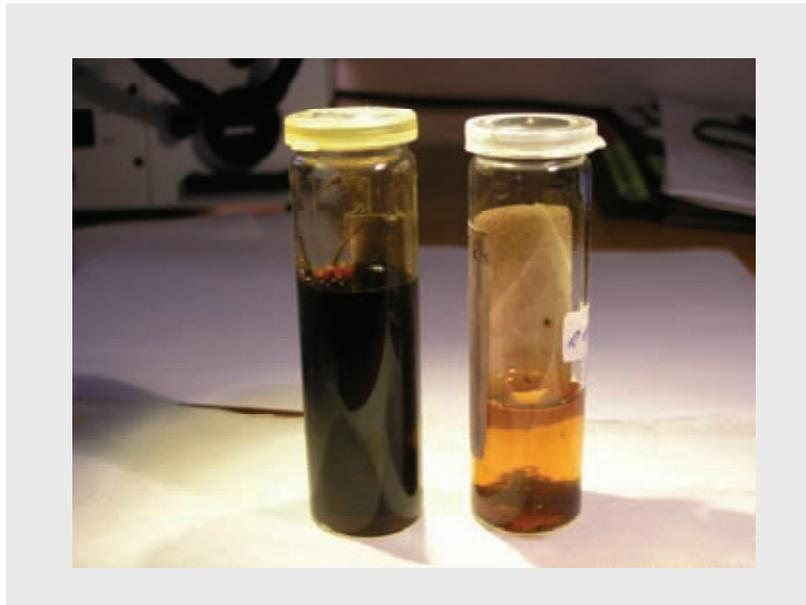
Abbildung 22: mit Lugol'scher Lösung fixierte Proben. Rechts ausreichende Fixierung (Kognak-Färbung), links Überfixierung.
