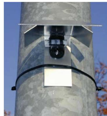
**Abbildung 1:** Passivsammler unter Schutzdach
