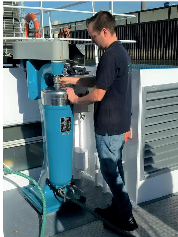
Mit der Zentrifuge an Bord der Max Prüss können Schwebstoffproben genommen werden
