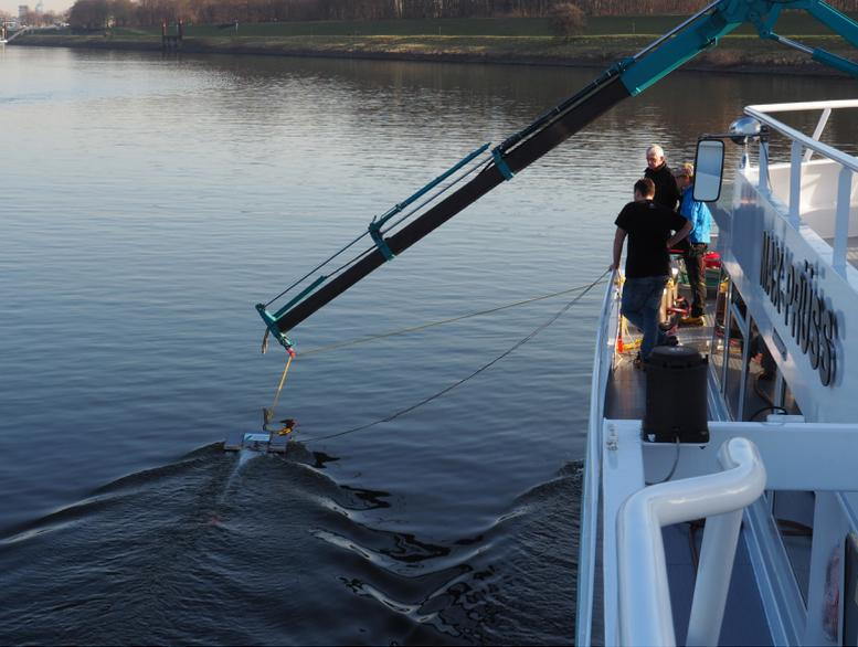
Mit einem sogenannten „MiniManta“-Netz werden von Bord der Max Prüss an verschiedenen Stellen des Rheins Mikroplastik-Proben entnommen
