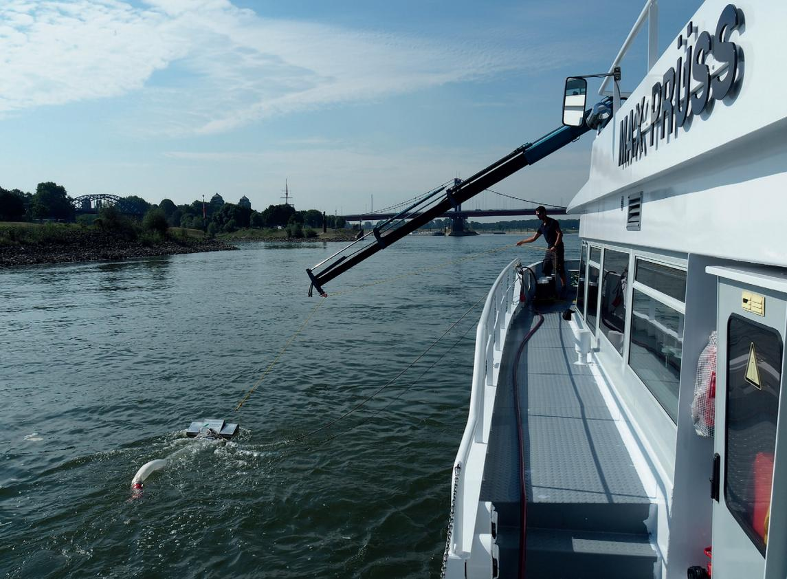
Mikroplastik-Probenahme an der Wasseroberfläche mit einem sogenannten Mini-MantaTrawl vom Forschungsschiff Max Prüss aus
