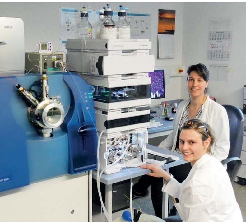
Mit einem hochauflösenden Time-of-flight Massenspektrometer sucht das LANUV nach unbekanntem Verbindungen im Wasser
