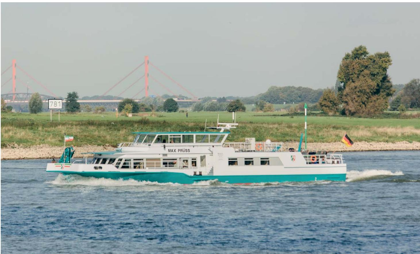
Das Laborschiff „Max Prüss“ wurde 2015 mit Partikelfiltern und einer Anlage zur Stickoxidreduktion nachgerüstet und stößt jetzt deutlich weniger Luftschadstoffe aus
