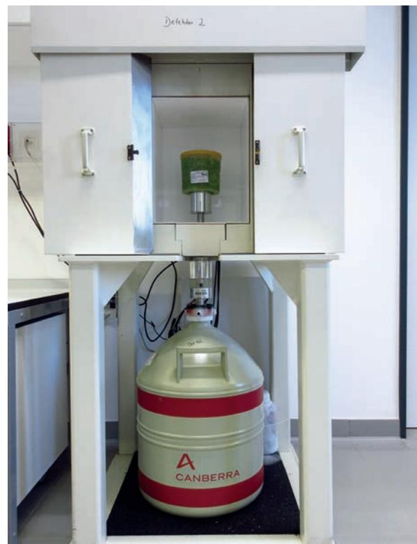
Alle eintreffenden Proben werden zur Aktivitätsbestimmung auf den Gammadetektor gesetzt. Im Bild zu sehen ist ein Gammadetektor mit Flüssigstickstoffkühlung und Bleiabschirmung. Die zu messende Probe befindet sich in einer Ringschale auf der Detektorendkappe.
