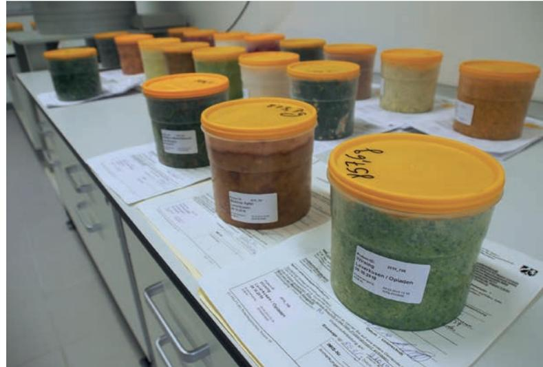
Die befüllten Ringschalen warten auf ihre Messung auf einem der vier Gammadetektoren. Insgesamt wurden während der Übung 113 Proben von Lebensmitteln und anderen Umweltbereichen angeliefert, für die Messung vorbereitet und in Ringschalen eingewogen.
