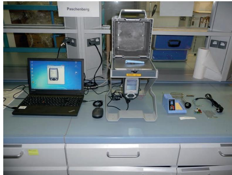
Mittels Röntgenfluoreszenzanalyse werden Produkte auf bestimmte Schadstoffe im Screening untersucht
