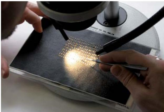
Unter dem Mikroskop wird geprüft, ob sich Samen anderer Arten in dem Saatgut befinden
