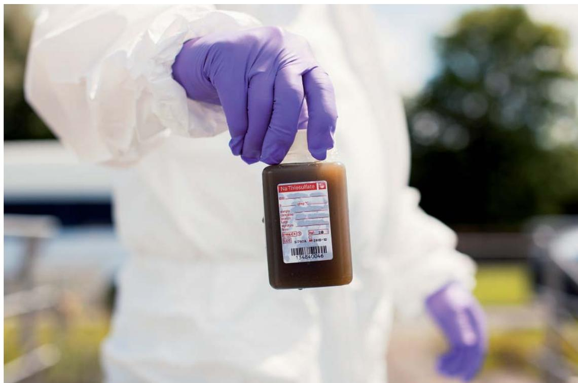
Die Wasserprobe geht zur Überprüfung auf Legionellen ins Labor
