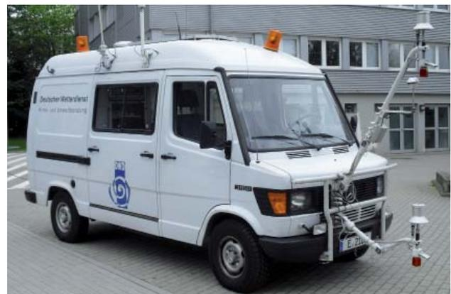
Mit einem Messfahrzeug wurden zusätzlich Temperaturmessfahrten im Stadtgebiet durchgeführt
