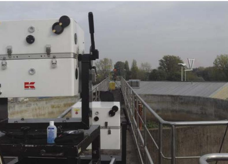
Abb. 2: FTIR-Messungen über einem Faulschlammstapelbehälter
