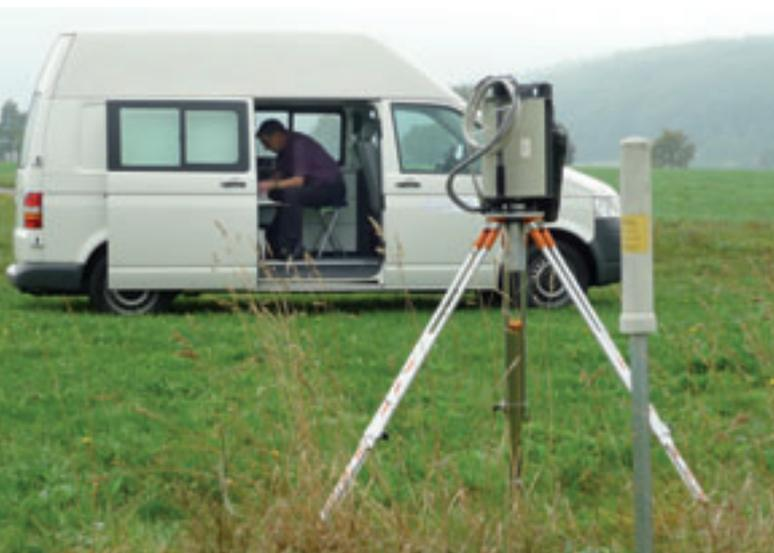
In-Situ-Gammaspektrometrie: Nach der halbstündigen Messung erfolgt die Datenübertragung per W-LAN vom Detektor zum Auswerte-PC im Einsatzfahrzeug
