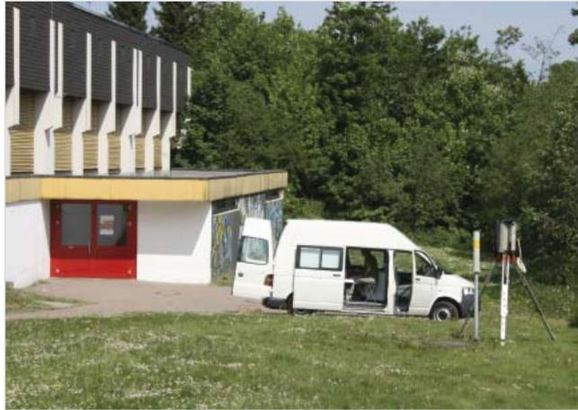
In-Situ-Messung auf dem Gelände einer Schule neben einer Gamma-Ortsdosisleistungs-Messstelle (Stab rechts vom Auto) des Bundesamtes für Strahlenschutz
