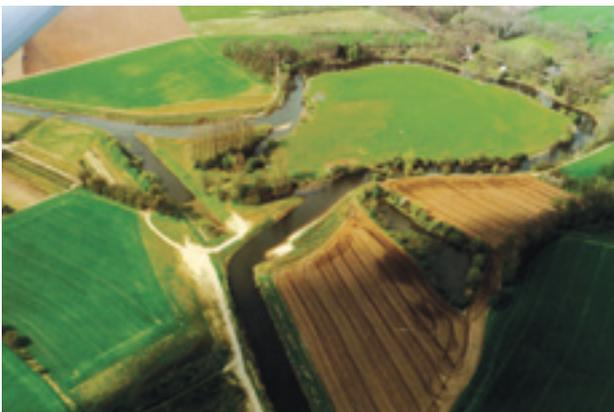
Abb. 221: Laufverlängerung durch Wiederanbindung einer alten Emsschleife
