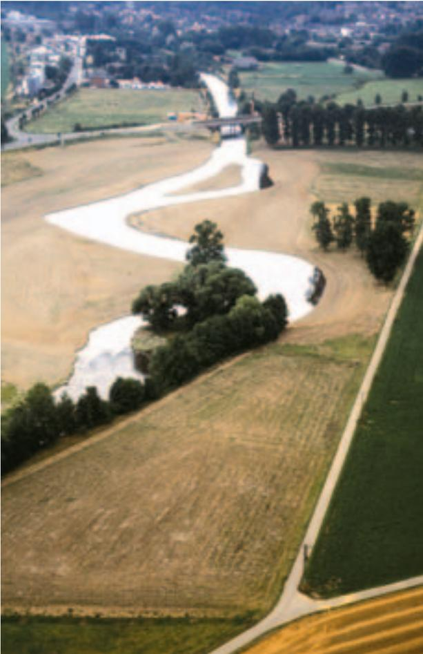
Abb. 226: Rurlauf nach naturnahem Ausbau
