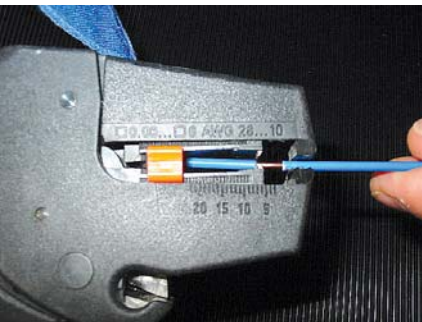
Abb. 2.23: Abisolieren mit selbstregulierender Abisolierzange (siehe Anhang)
