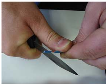
Abb. 2.21: Abisolieren mit dem Kabelmesser
