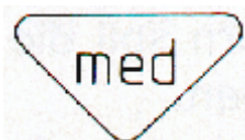
Abb. 8.38: Symbol Transformator für medizinische Geräte
