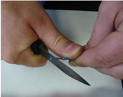
Abb. 2.21: Abisolieren mit dem Kabelmesser (siehe Anhang)
