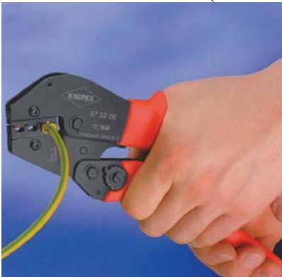
Abb. 2.28: Quetschzange bis zum Anschlag durchdrücken (siehe Anhang)
