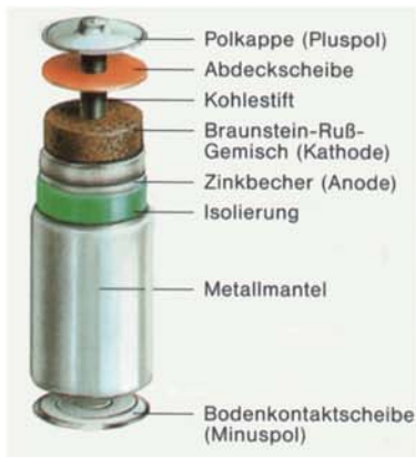
Abb. 9.7: Leclanché-Element Auslaufsichere Zelle mit Stahlmantel
