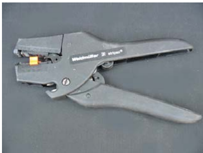
Abb. 2.15: Selbstregulierende Abisolierzange mit Drahtschneider (siehe Anhang)
