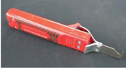
Abb. 2.6: Kabelmesser mit Hakenklinge (siehe Anhang)
