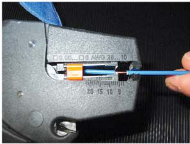
Abb. 2.23: Abisolieren mit selbstregulierender Abisolierzange
