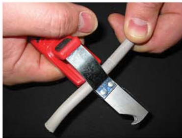
Abb. 2.19: Handhabung des Kabelmessers
