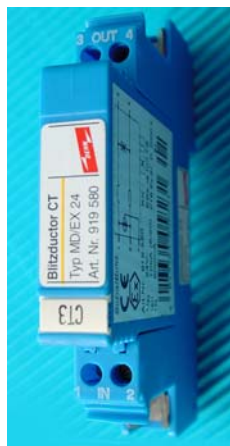
Abb. 8.50: Überspannungsschutz (siehe Anhang)
