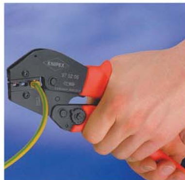
Abb. 2.28: Quetschzange bis zum Anschlag durchdrücken
