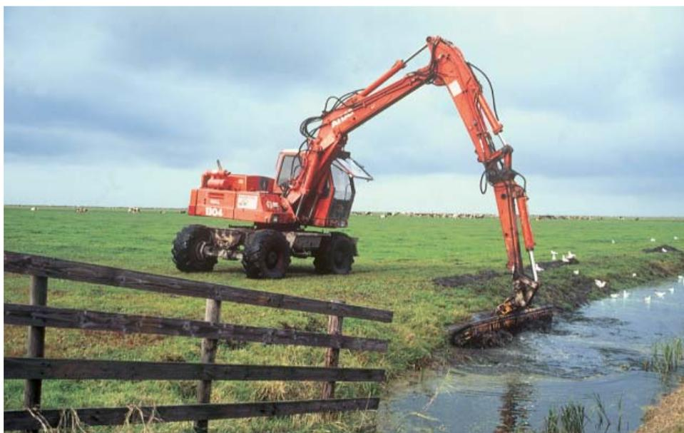
Abb. 4: Bei der Böschungsmahd / Grabenräumung empfiehlt sich die Verwendung eines Balkenmähers oder Mähkorbes.
