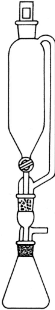
Abbildung 1: Prüfapparatur zur Ermittlung der Gasentwicklung
