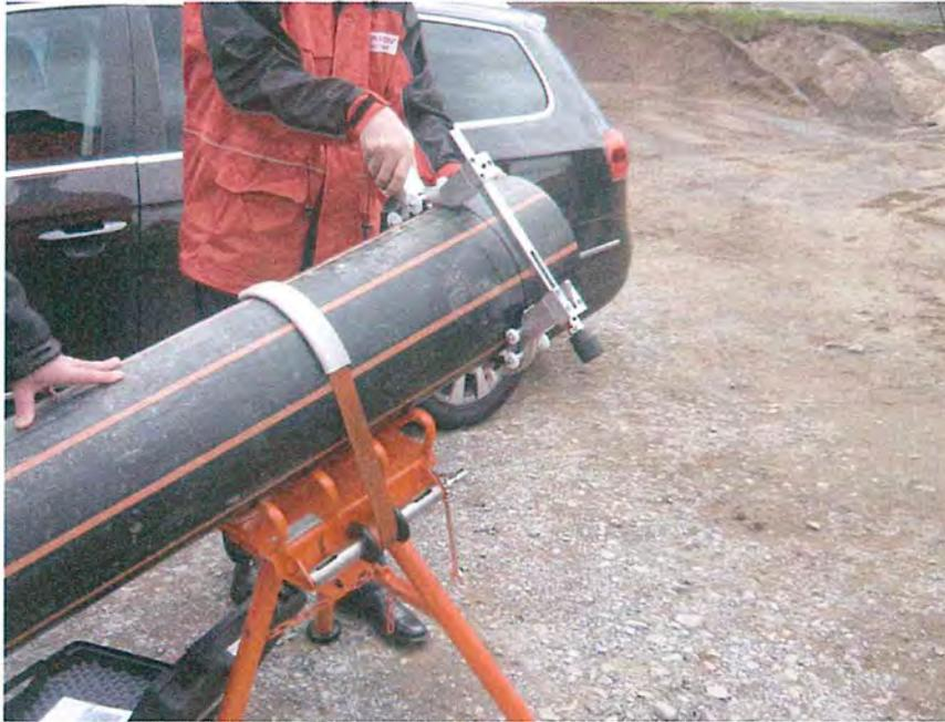
Abbildung 21 Einsatz eines Rohrschneiders, Foto, Klapp & Müller
