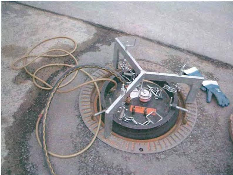
Abbildung 26 Dichtheitsprüfung mit Unterdruck, Foto, Klapp & Müller
