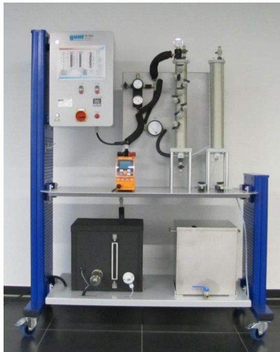
Abbildung 3.3-1: Versuchsanlage für die dynamischen Untersuchungen in Festbettschüttungen
