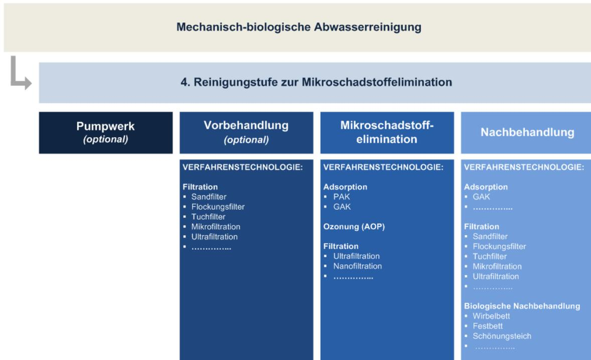
**Abbildung 3-1: Verfahrensschritte zur Mikroschadstoffelimination**
