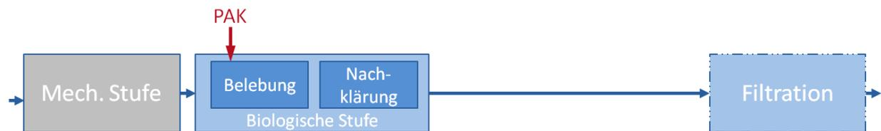
**Abbildung 3-8: Schematische Darstellung der simultanen PAK-Dosierung im Belebungsbecken (KOM-M.NRW, 2015b)**
