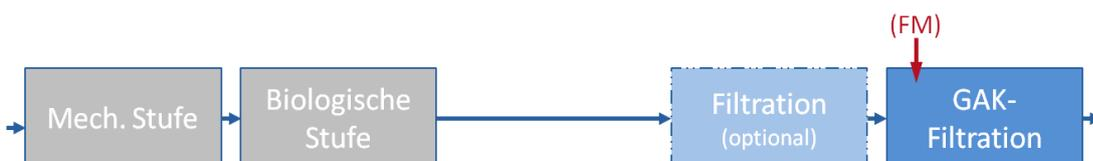
**Abbildung 3-4: Schematische Darstellung der Einbindung einer GAK-Filtration in den bestehenden Klärprozess (KOM-M.NRW, 2015b)**
