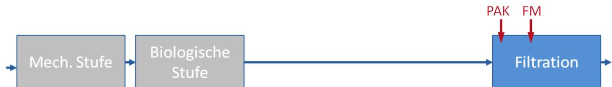
**Abbildung 3-6: Schematische Darstellung der PAK-Dosierung vor der abschließenden Abwasserfiltration (KOM-M.NRW, 2015b)**
