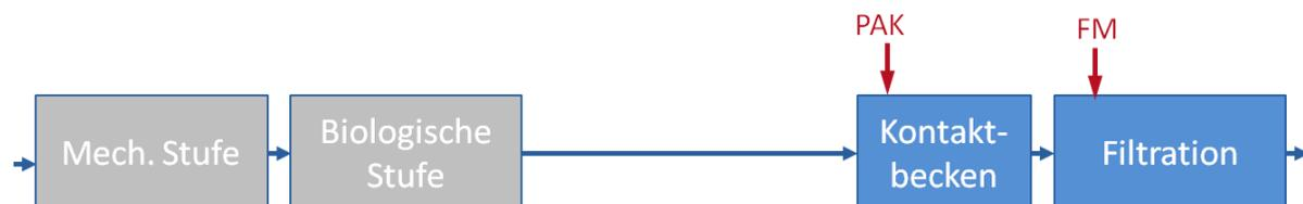
**Abbildung 3-7: Schematische Darstellung der PAK-Dosierung in den Zulauf zur Filtration mit separatem Kontaktbecken (Flockungsraum) (nach Herbst und Hilbig, 2012)**
