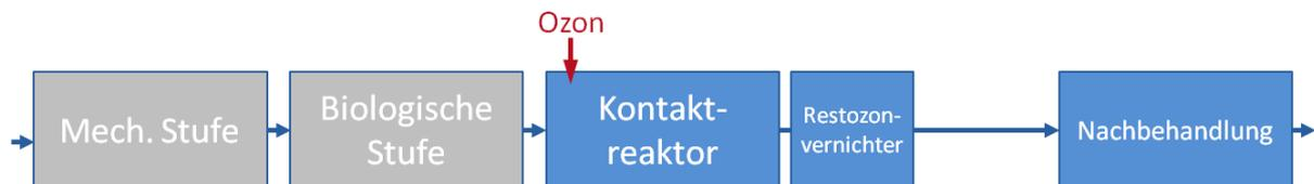
**Abbildung 3-2: Schematische Darstellung der Einbindung einer Ozonung in den bestehenden Klärprozess (KOM-M.NRW, 2015b)**
