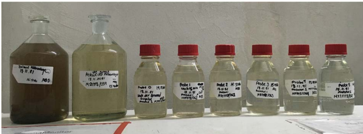
Abbildung 6: Abnehmende Färbung einer Abwasserprobe vom Zulauf zur Biologie (linke Flasche) über den Ablauf der Kläranlage (2. Flasche von links) bis hin zum Ablauf der USONiQ-Ozonung (kleine Flaschen mit von links nach rechts steigender spezifischer Ozondosis).
