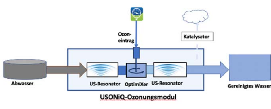
Abbildung 1: Schematische Darstellung der USONiQ-Ozonung (Quelle: USONiQ).
