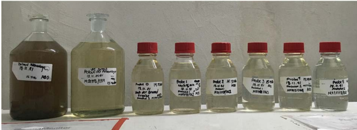
Abbildung 23: Abnehmende Färbung einer Abwasserprobe vom Zulauf zur Biologie (linke Flasche) über den Ablauf der Kläranlage (2. Flasche von links) bis hin zum Ablauf der USONiQ-Ozonung (kleine Flaschen mit von links nach rechts steigender spezifischer Ozondosis).
