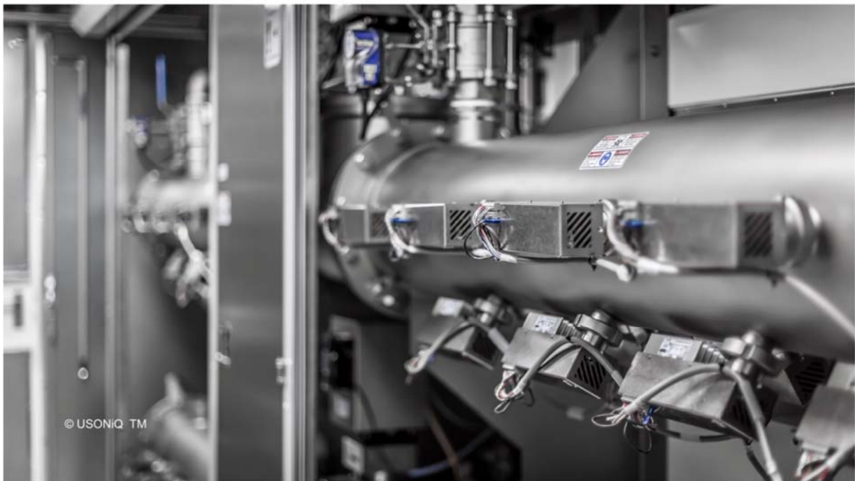
Abbildung 8: Rohrreaktor der USONiQ-Ozonung mit Ultraschallresonatoren und OptimiXer®.
